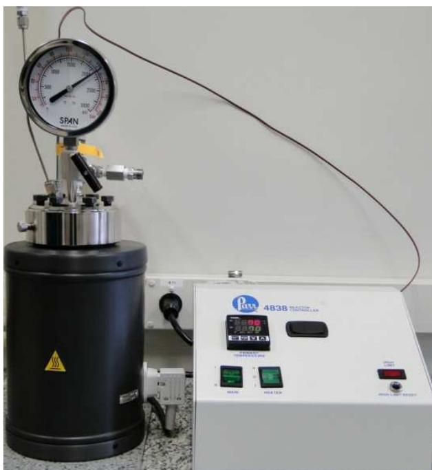
Figura 6.3. Reator Parr utilizado para realização dos ensaios de corrosão a alta pressão. Fonte: o autor.
