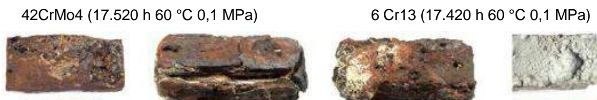
Figura 3.21. Imagens de superfícies das amostras expostas ao meio aquoso saturado com CO 2 em aquífero salino, a 60 °C em pressão ambiente. Fonte: Adaptado de. Pfening et al. , 2011.
