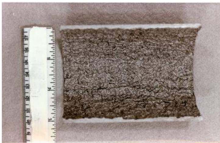
Figura 3.2. Corrosão uniforme em aço por \text{CO}_2 . Fonte: Go-Tech, 2015.
