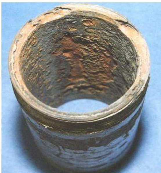
Figura. 3.3. Corrosão por pitting em tubo de aço. Fonte: Go-Tech, 2015.
