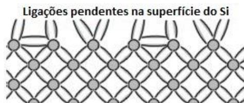
Figura 2.1. Ilustração dos defeitos causados pelas ligações pendentes na superfície do Si (ligações no topo da estrutura) (BOWDEN; HONSBURG).
