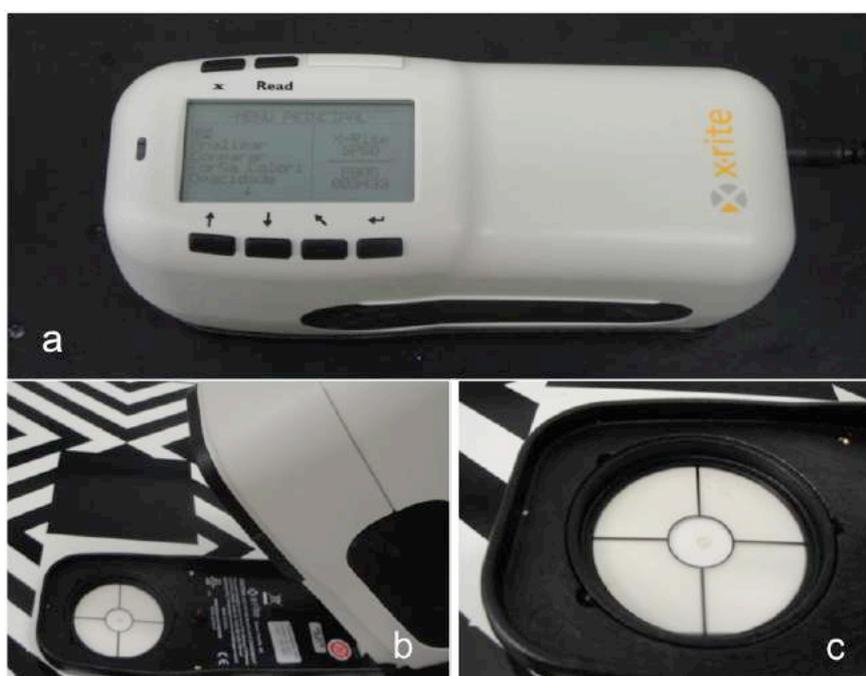
Figura 02. a) Espectrofotômetro portátil SP60 (X-Rite); b,c) Medição da amostra em T0
