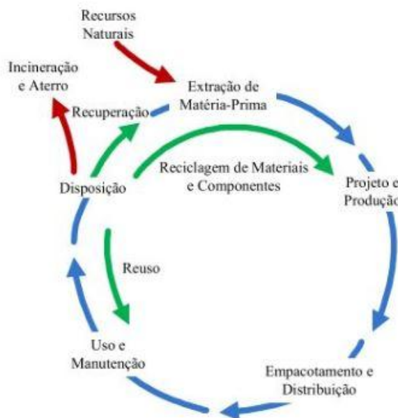
Figura 1 - Esquema Representativo de uma Abordagem do Ciclo de Vida.
