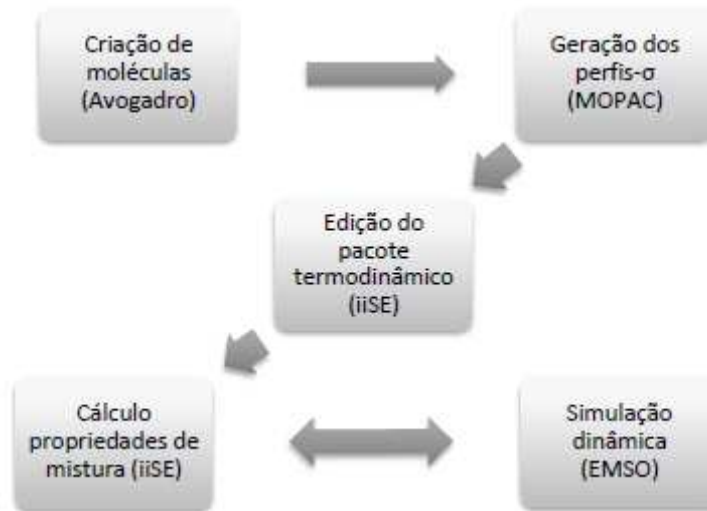
Figura 4.8 Etapas para simulação do processo de destilação fracionada de óleos essenciais.
