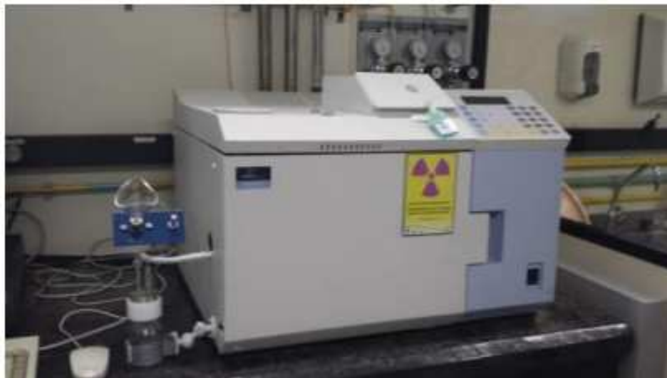
Figura 4.6 Equipamento híbrido (GC/O) para análises olfatométricas.
