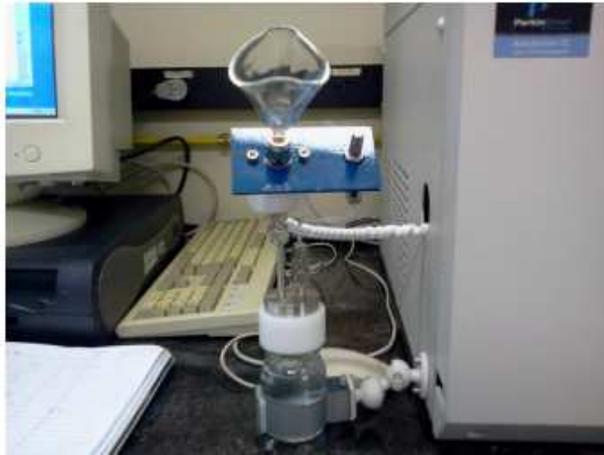
Figura 4.5 Olfatômetro acoplado ao cromatógrafo a gás.
