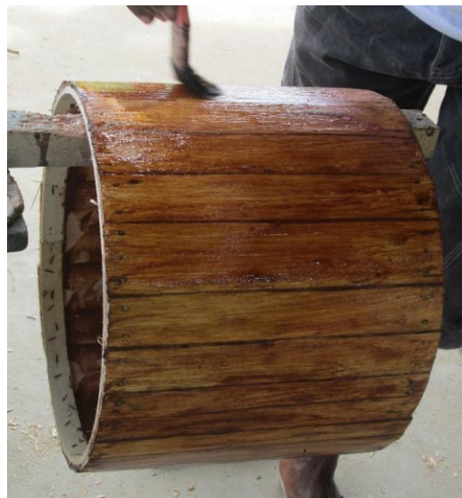
Figura 20 – A “caixa” sendo pintada com verniz
