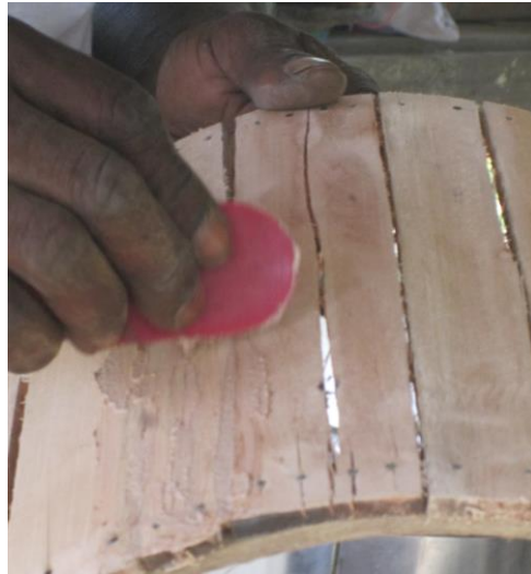
Figura 19 – Preparação da “caixa” durante a selagem
