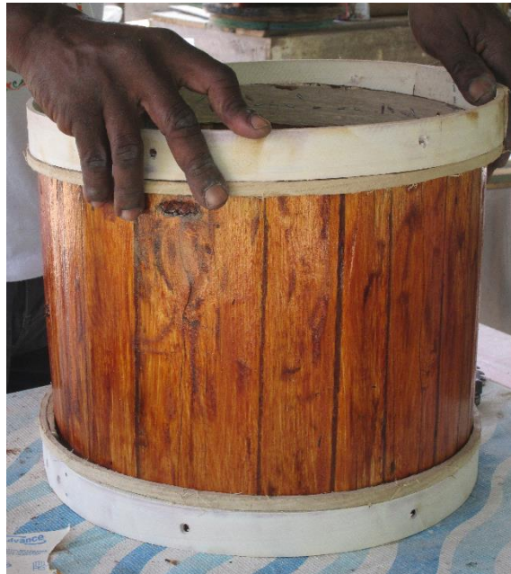
Figura 11 – Colocação do Aro para que seja possível fazer o encordamento
