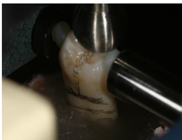
Figura 6: Micrômetro posicionado nas esferas de resina composta e aplicação da carga de 200 N ou 300 N na região oclusal com esfera de aço de 8 mm de diâmetro.
