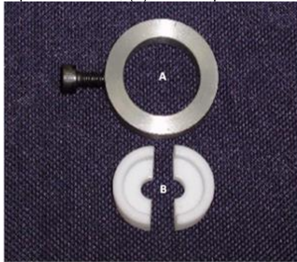
Figura 1 – Dispositivo para confecção das amostras para o teste de tração diametral: (A) suporte metálico; (B) matriz bipartida de PTFE
