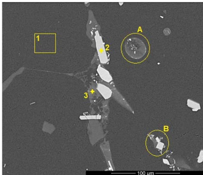
Figura 5.46 - Identificação dos pontos onde foi medido a composição química nas estruturas apresentadas na posição 5 da Liga II ( Al-6,5%Si-0,6%Mg) após tratamento térmico de solubilização.
