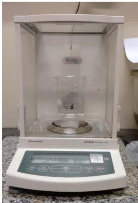
Figura 4.10 - Instrumentos utilizados para determinação da massa específica aparente das amostras pelo método de picnometria.
