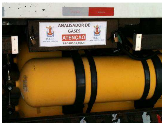
Figura 0.3. Dispositivo para armazenar o analisador de gases embarcado no veículo.
