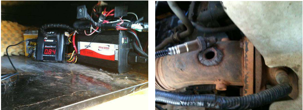
Figura 0.6. Conversor de energia e display da Sonda Lambda, e Sonda Lambda instalada.
