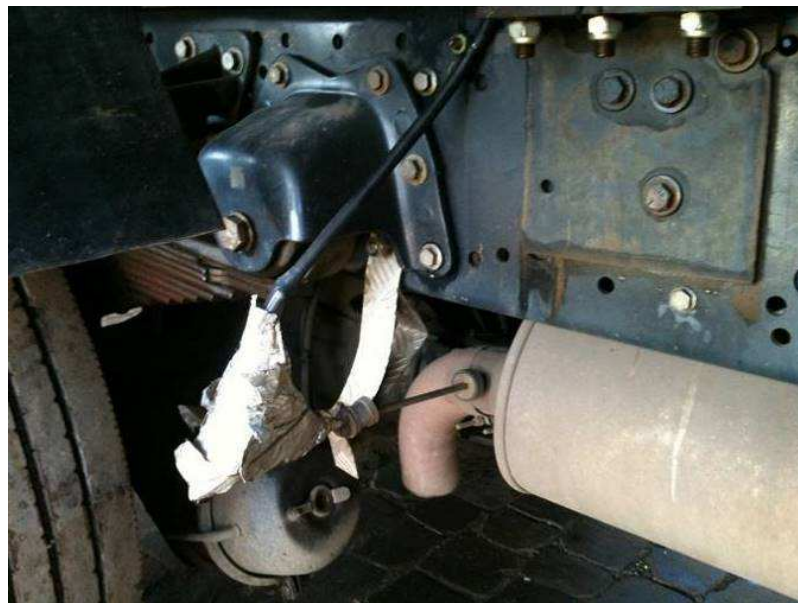
Figura 0.5. Sonda metálica de análises dos gases de exaustão.
