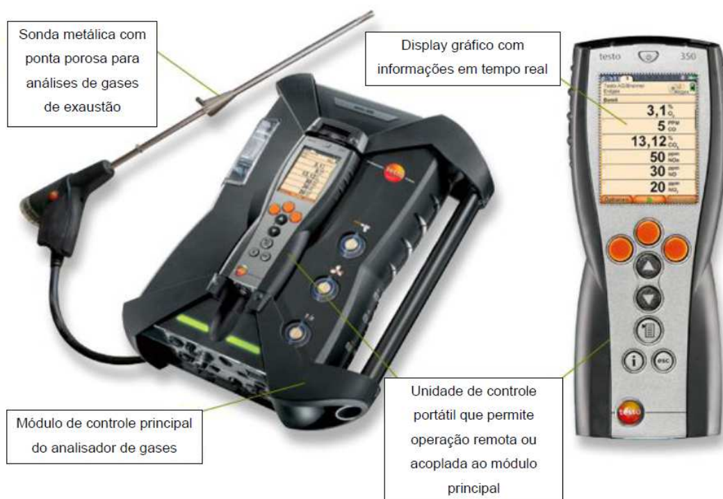
Figura 0.4. Analisador de gases portátil (Testo 350).
