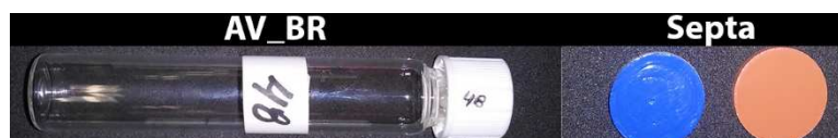
Figura 3 –Frasco alternativo e septos utilizados na coleta e estocagem das amostras gasosas.
