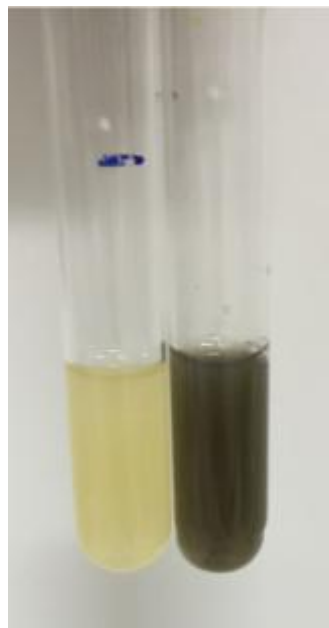
Figura 5.3. Reação com cloreto férrico: à esquerda, o extrato bruto; à direita, o extrato com cloreto férrico 2%.
