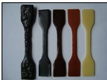
Figura 4 - Amostras submetidas à ação térmica em 260°C, 240°C, 200°C, 160°C e 80°C.
