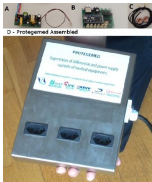
Figura 2: Instalação do kit Protegemed - A: Uma fonte de energia elétrica (110/240 Vac para 7,5 Vdc); B: Placa do microcontrolador; C: sensores de corrente elétrica (3 pares); D: Caixa de metal com tomadas, com kit do Protegemed dentro (A, B, C).
