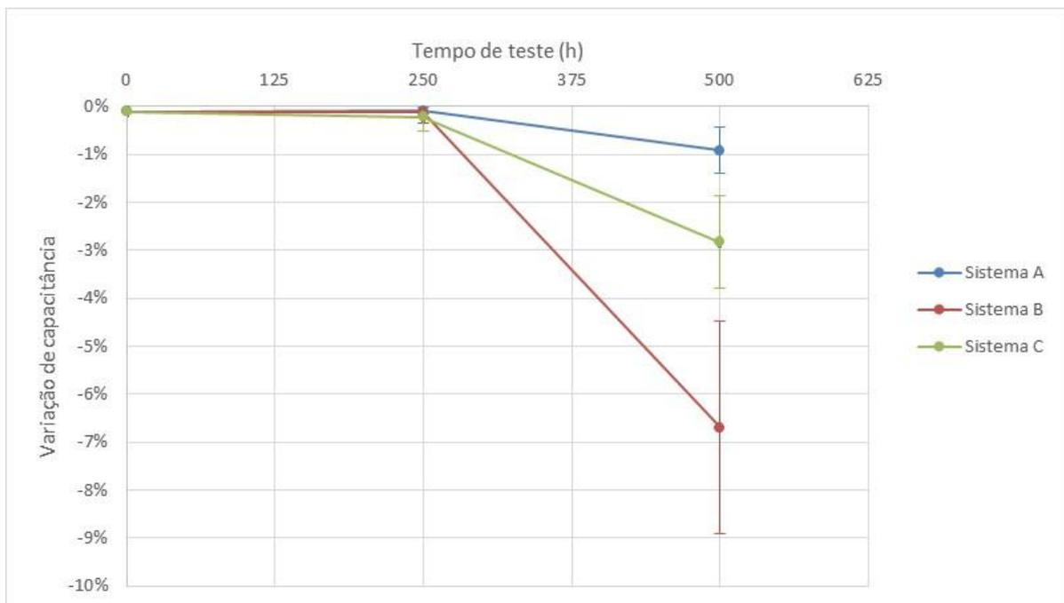
Figura 5.17. Variação de capacitância no ensaio de temperatura máxima de operação.
