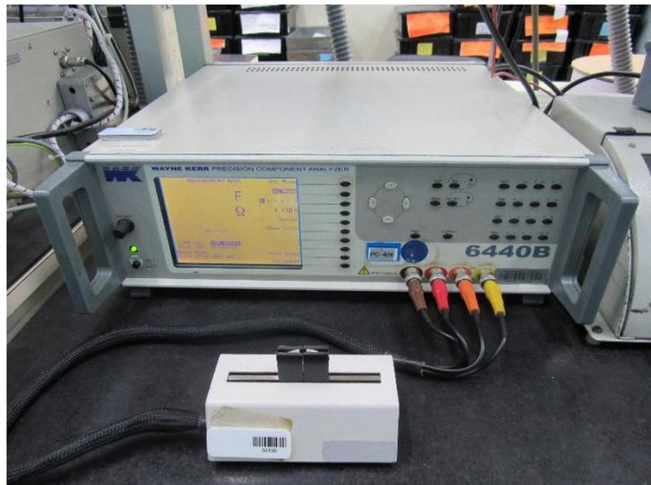
Figura 4.7. Ponte Wayne Kerr para medição de capacitância.
