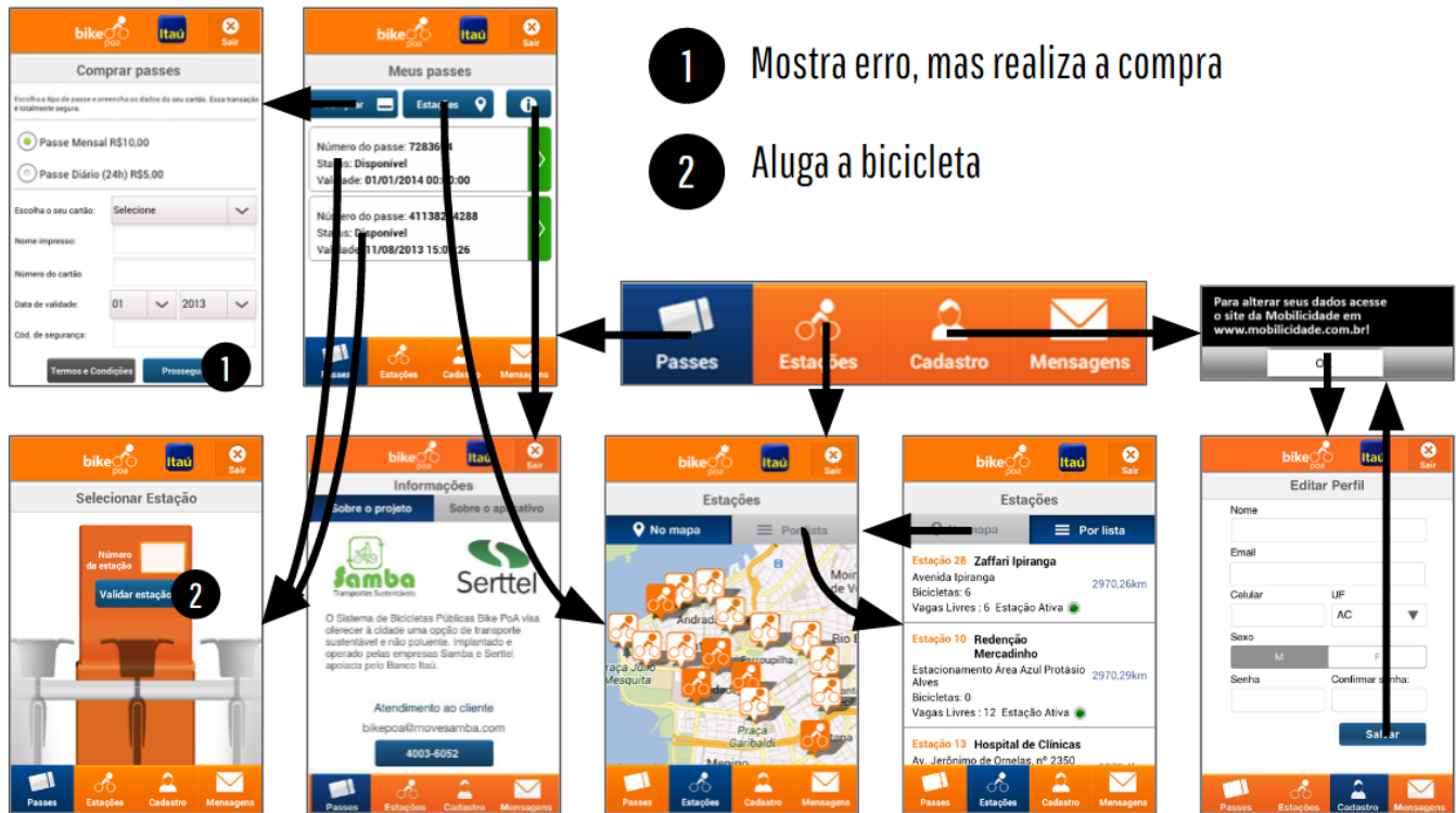
Figura 12: Mapa dos signos dinâmicos, mostrando as transições entre as telas do aplicativo.
