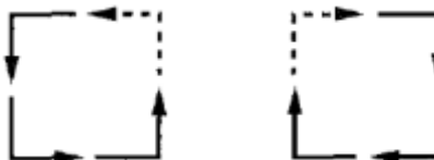
Figura 5.6 – Os seis turns permitidos para o algoritmo north-last (setas sólidas) [DUA03].
