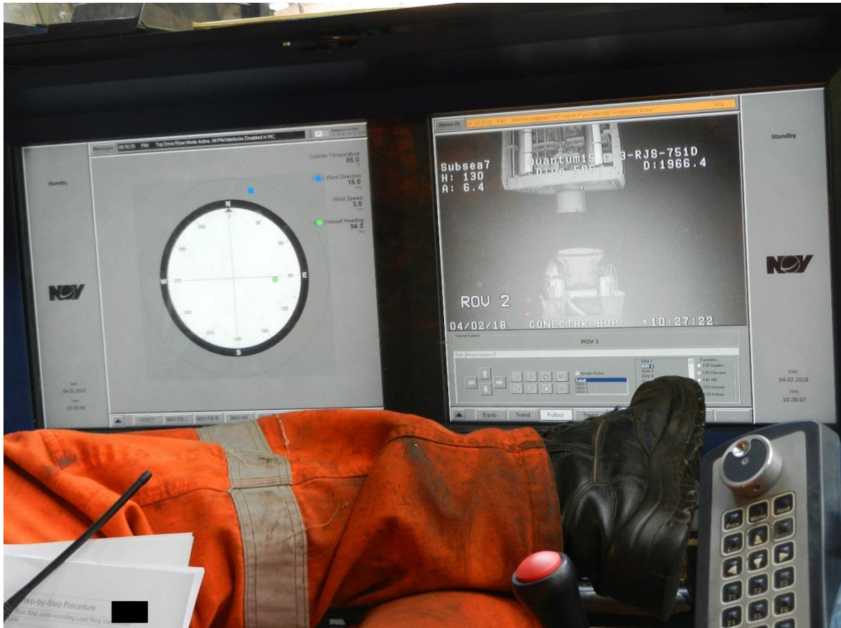
Imagem 2 – Alinhamento do BOP sobre a cabeça do poço
