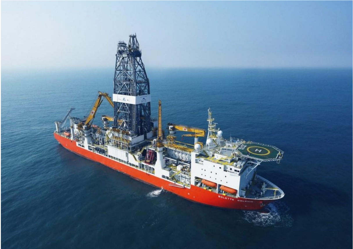
Imagem 1 – Exemplo genérico de unidade de perfuração do tipo drillship
