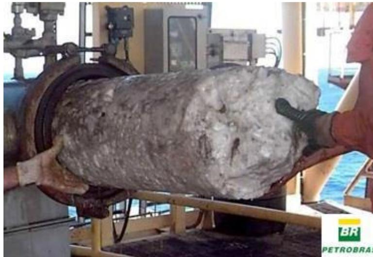
Figura 3.1 Remoção de um *plug* de HG de uma tubulação (Milovanovic, 2014).
