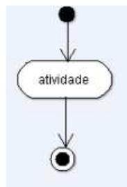
Figura 4.1: Diagrama de atividades com elemento estado-inicial e estado-final
