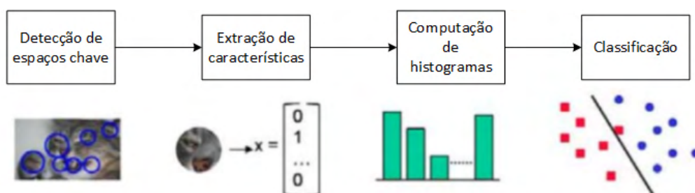
Figura 2.3 – Um processamento de pipeline típico de um reconhecimento de imagens utilizando técnicas de bag of words [65].
