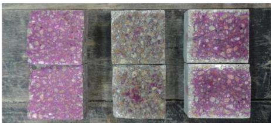
Figura 2.12: Aplicação da solução indicadora de fenolftaleína em uma superfície de fratura recente de concreto. Da esquerda para a direita C100, C50-1-0 E C50-1-20 (LORCA et al., 2014).
