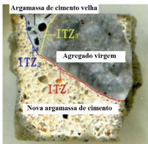
Figura 2.4: Diagrama esquemático da microestrutura do agregado reciclado de concreto (ZHANG et al. 2019)
