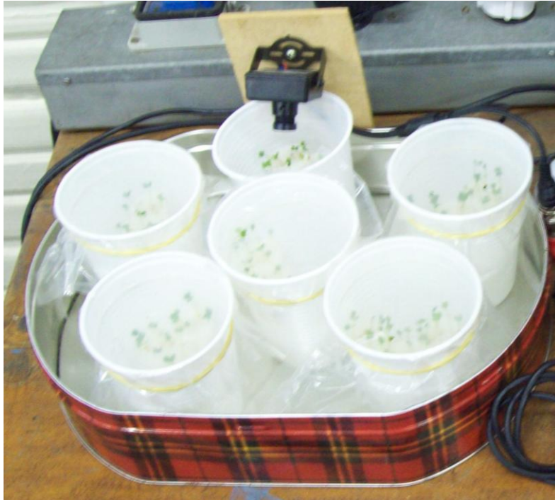
Figura 30 - Sistema de captação de imagens do controle. A minicâmera está fixada em um suporte de madeira e os recipientes de amostras encontram-se organizados dentro de uma caixa metálica
