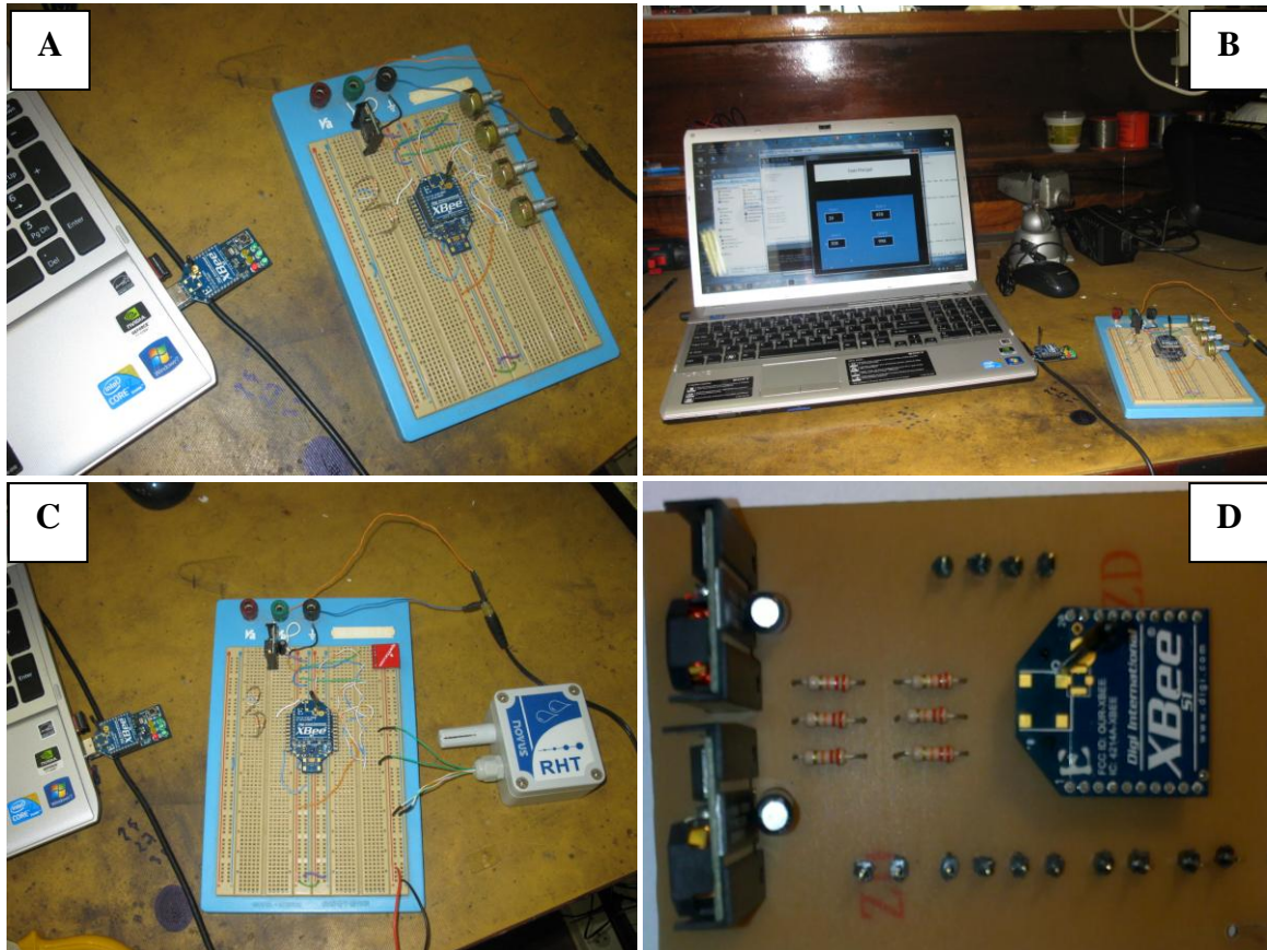
(A) primeiro teste de montagem do sistema de transmissão de sinais dos sensores, usando-se potenciômetros; (B) sinais sendo recebidos pelo programa desenvolvido; (C) segundo teste de transmissão do sinal, empregando os sensores propriamente ditos; (D) placa reguladora de tensões finalizada. Fonte: o autor (2012).
