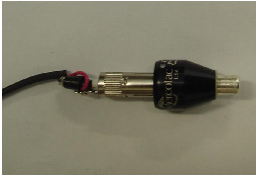
Figura 36 – Conector rotativo empregado, já com os cabos da fonte ligados a um de seus terminais soldáveis
