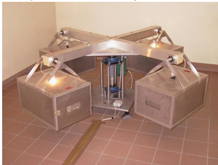
Figura 3 – Protótipo de centrífuga de baixo custo desenvolvido pela Universidade de Moscou
