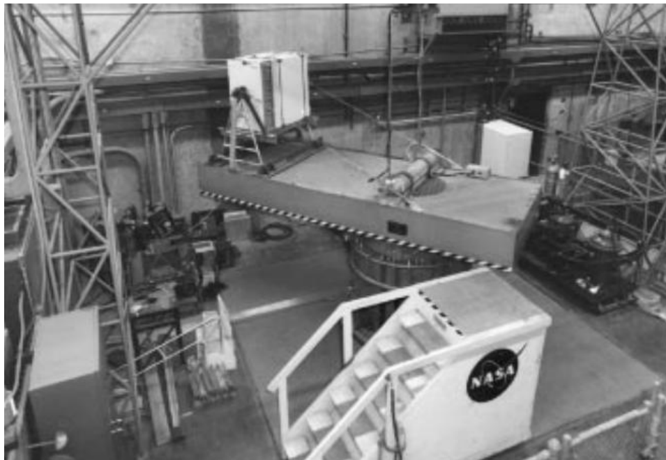
Figura 1 - Centrífuga HyFaBR para estudos com hipergravidade em plantas
