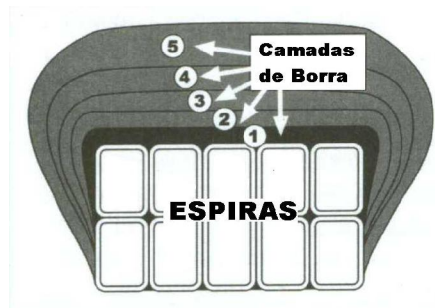
Figura 20 - Seção transversal das espiras de um transformador [17].
