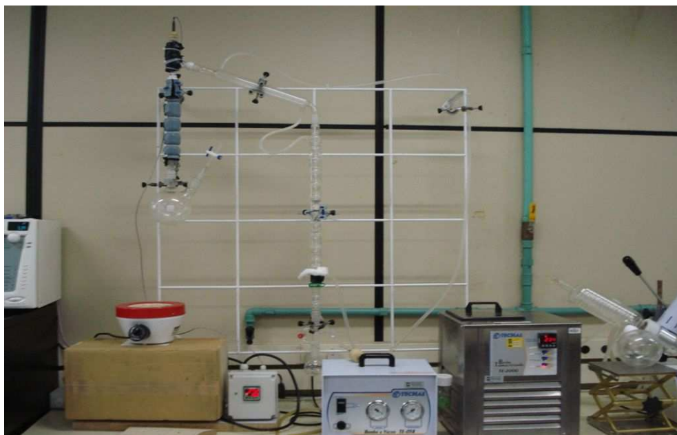
Figura 4.2. Aparelho de destilação fracionada coluna 50 cm.
