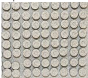
Figura 2: Placa de Alumínio com os implantes após a deposição do revestimento poroso.
