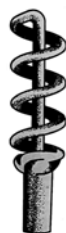
Figura 7 Parafuso espiralado de Andrés Perron, derivação e aperfeiçoamento do parafuso proposto por Formiggini. Fonte: [34].
