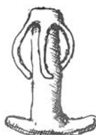
Figura 4 Protótipo da raiz metálica de ouro, idealizada pelo dentista italiano Maggiolo, em 1807, no desenho original de seu livro. Fonte: [34].
