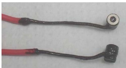
Figura 26 Amostras adaptadas no porta amostras para ensaio de resistência à corrosão.
