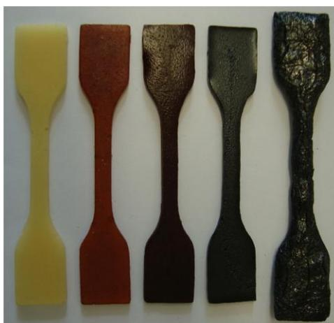
Figura 5.28 - Corpos de prova após teste térmico a 80°C, 160°C, 200°C, 240°C e 260°C.
