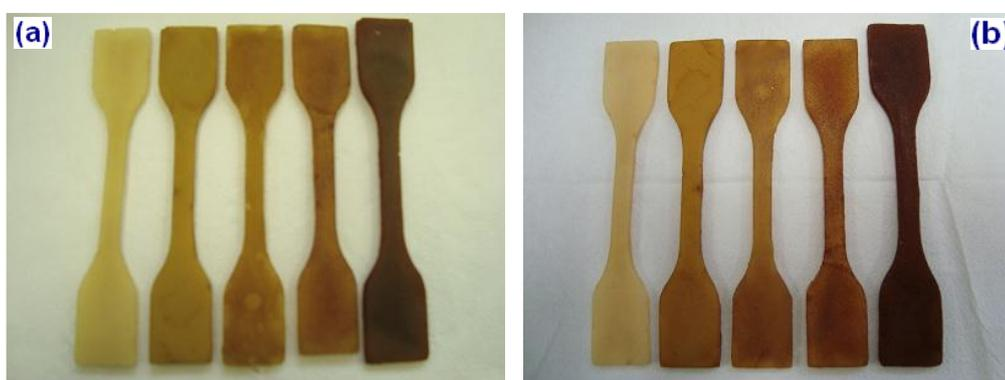
Figura 5.33 - Amostras com 30%, 40%, 50%, 60% e 70% de agente de cura, após imersão: (a) 35 dias; (b) 64 dias.
