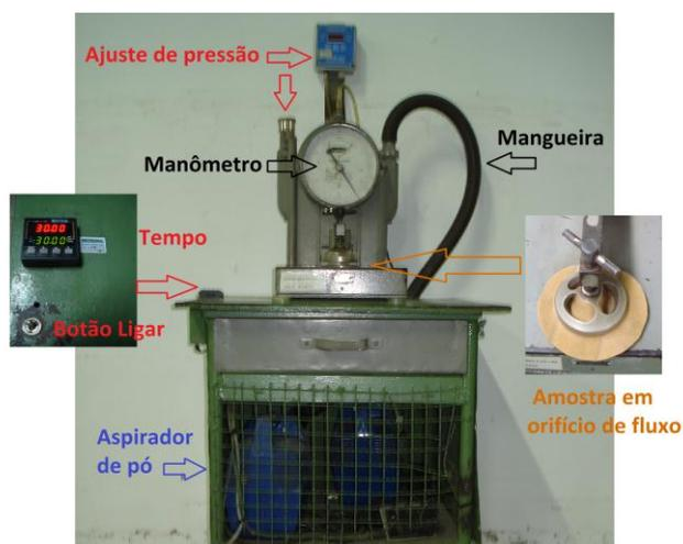
Figura 4.6 - Permeabilímetro.
