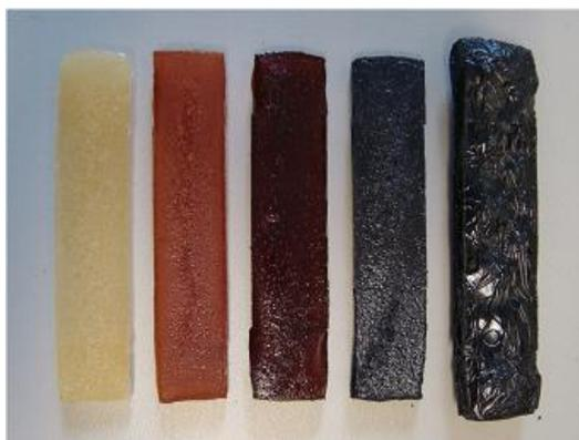
Figura 5.38 - Amostras após a 80°C, 160°C, 200°C, 240°C e 260°C.
