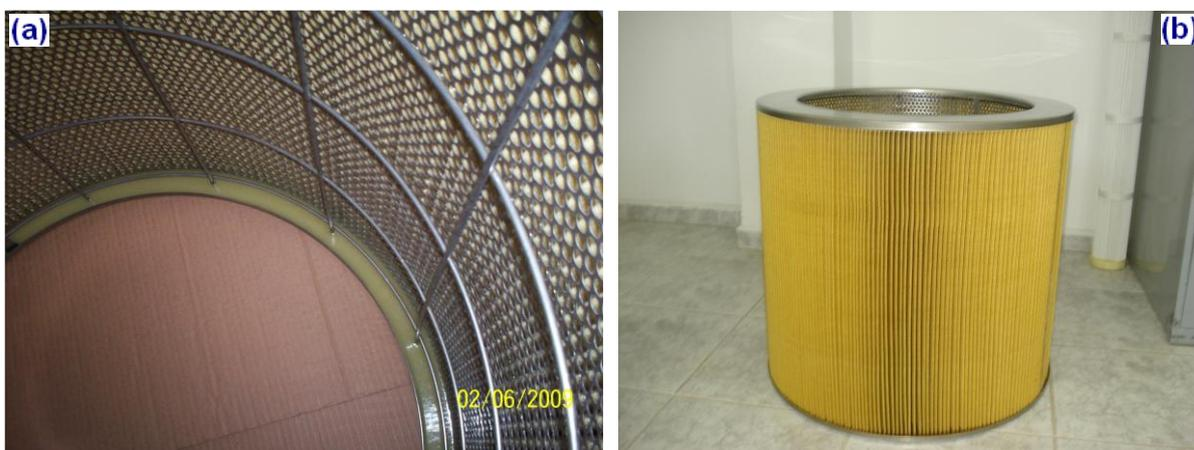
Figura 4.11 - (a) Tela metálica interna; (b) Filtro cartucho de PI.
