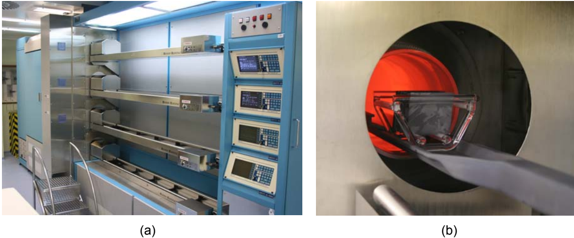
Figura 4.5. (a) Forno de difusão da marca Bruce e (b) detalhe das lâminas saindo do forno.
