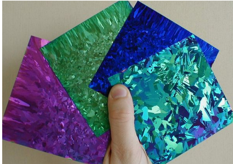
Figura 2.6. Lâminas de Si-mc cobertas com filmes de Si 3 N 4 de diferentes espessuras.
