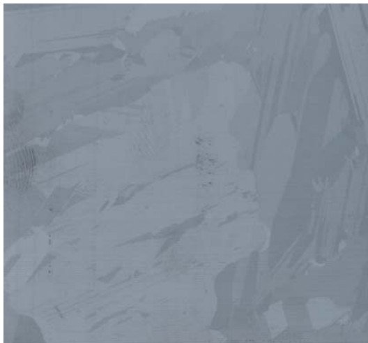
Figura 4.1. Lâmina de silício multicristalino com área de 60 mm x 60 mm.
