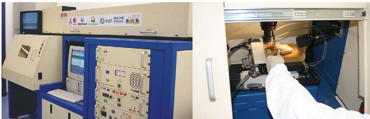
Figura 2.13. (a) Equipamento destinado à separação da região n^+ da p^+ nas bordas das lâminas de silício e (b) detalhe interno do equipamento.
