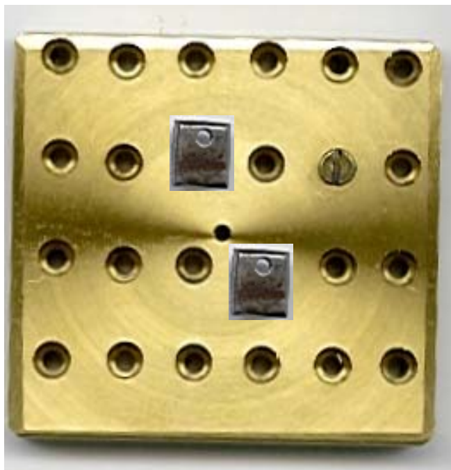
Figura 31: Porta-amostra para polimento e padrão de amostras aço ABNT 1020.
