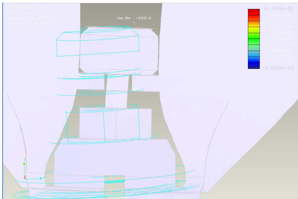
Figura 42. Deformação na haste do parafuso protético.
