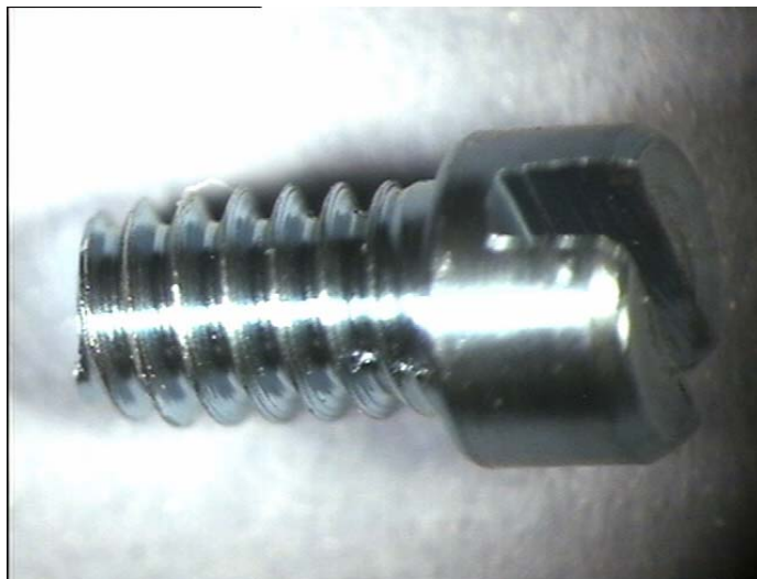
Figuras 23. Parafuso de titânio visto através de uma lupa.
