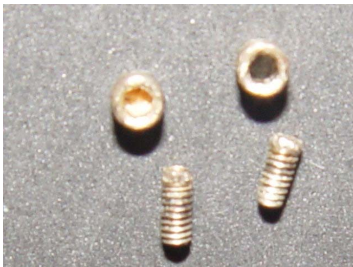
Figura 20. Parafusos protéticos de ouro fraturados após a reabilitação sobre implante ter sido finalizada.
