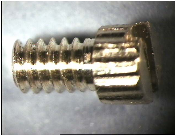
Figuras 22. Parafuso de ouro visto através de uma lupa.
