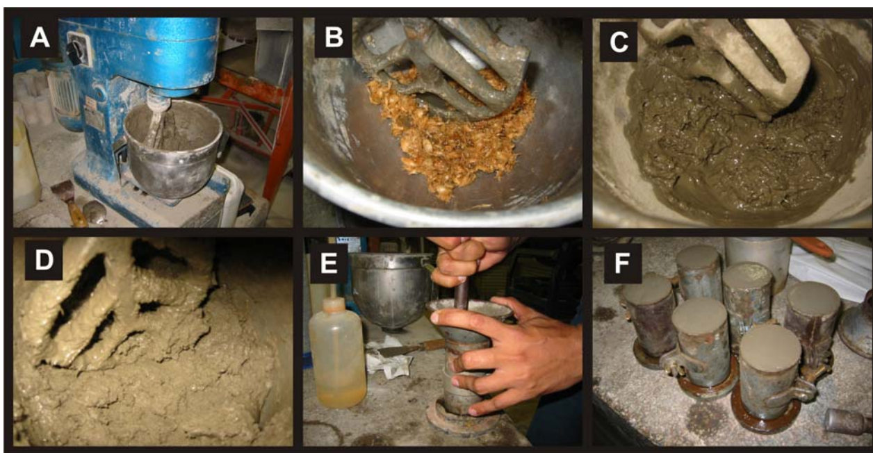
Figura 3.8 – Fotografias da (A) argamaseira; (B) fibras e metade d'água; (C) fibras, parte d'água e parte do cimento; (D) mistura completa; (E) adensamento; e (F) corpos-de-prova moldados.
