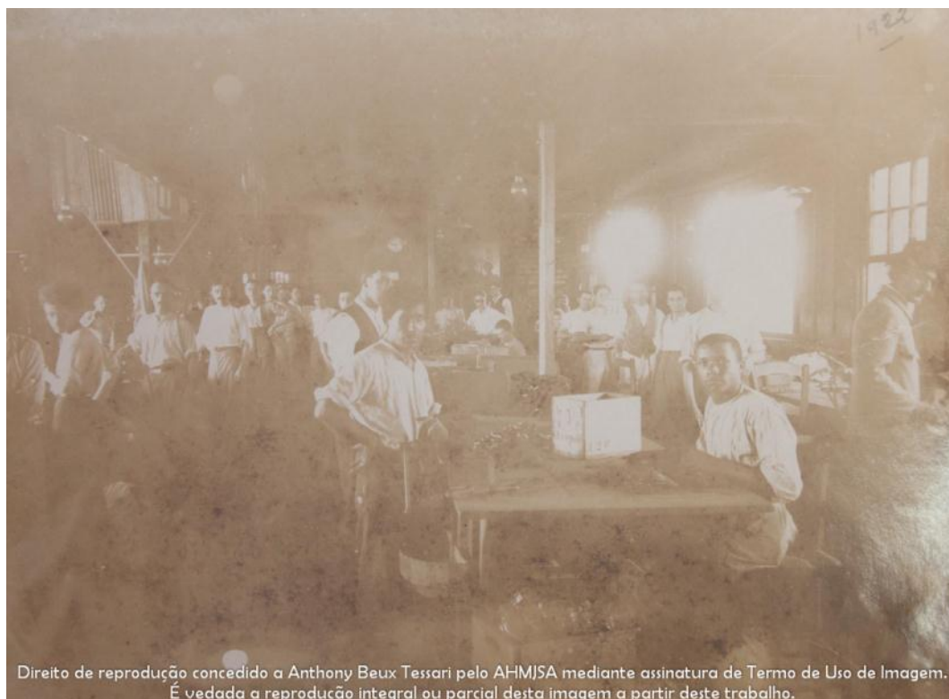
037 – Ano de 1922 – A parte da fábrica encarregada da limagem de artigos fundidos, estampação e esmerilhação. À direita vê-se o sr. Alberto Bellini.
