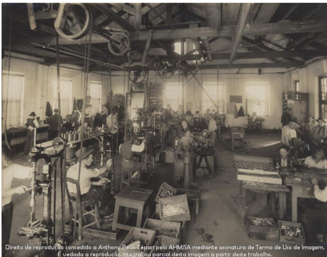
070 – Ano de 1925 – Secção limagem e montagem artigos fundidos.
