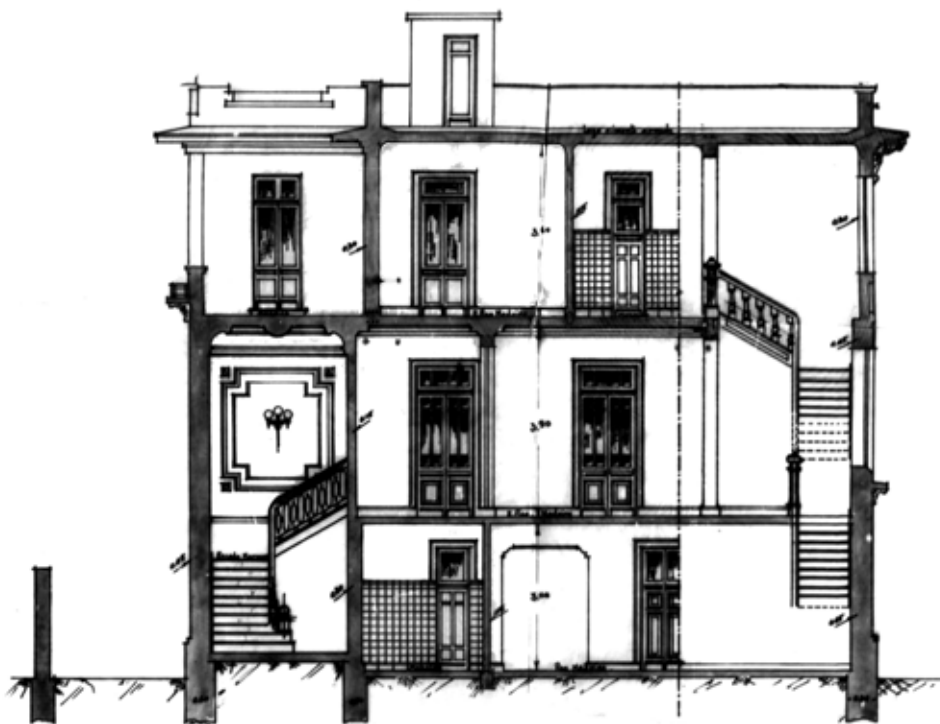
Imagem 106 – Casa Adroaldo Mesquita da Costa – corte transversal, Porto Alegre (1929) – Saul Macchiavello e Antonio Rubio. Fonte: Arquivo Municipal – microfilme n° 040 – (1929) – projeto n° 14.403.
