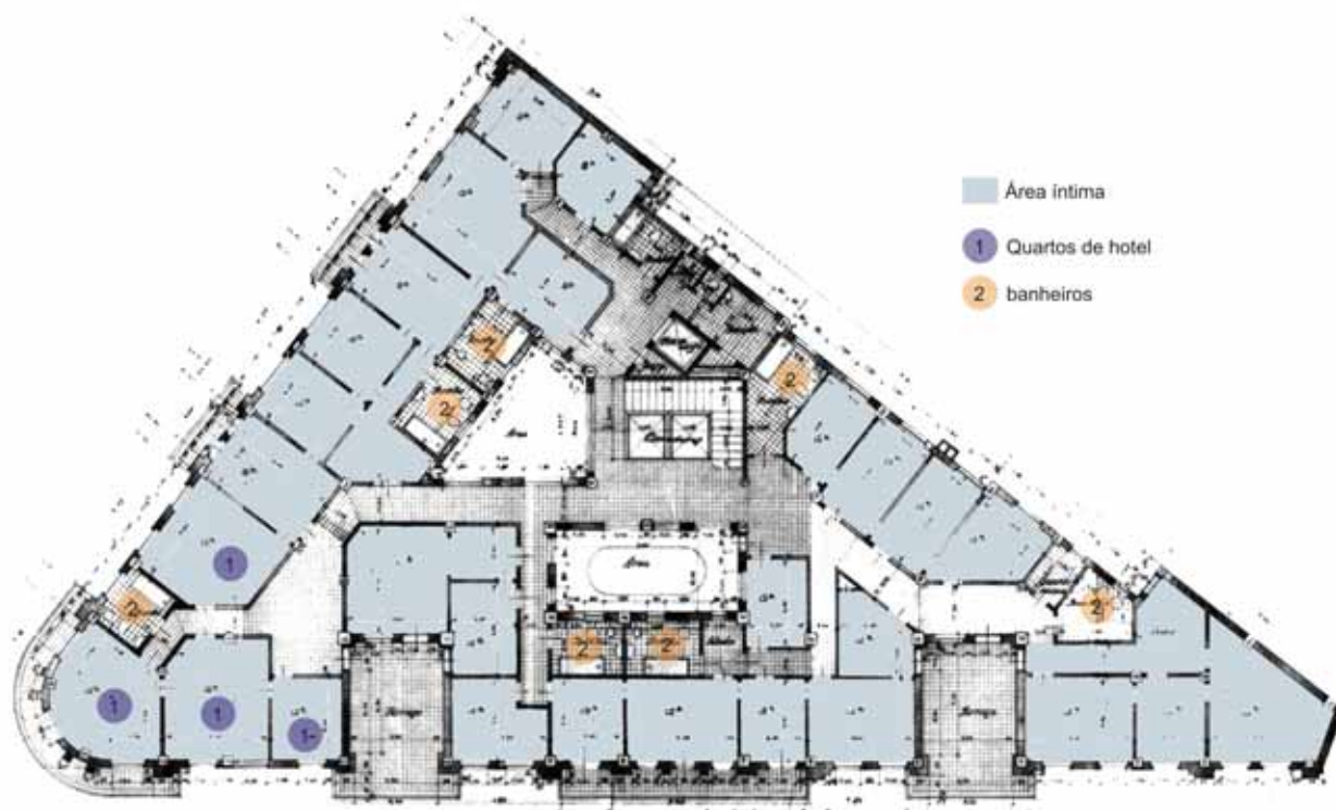
Imagem 147 – Edifício Comendador Chaves – planta segundo pavimento – hotel, Porto Alegre (1933) – Saul Macchiavello e Antonio Rubio. Fonte: Arquivo Municipal – microfilme nº 056 – (1933) – projeto nº 12.796.
