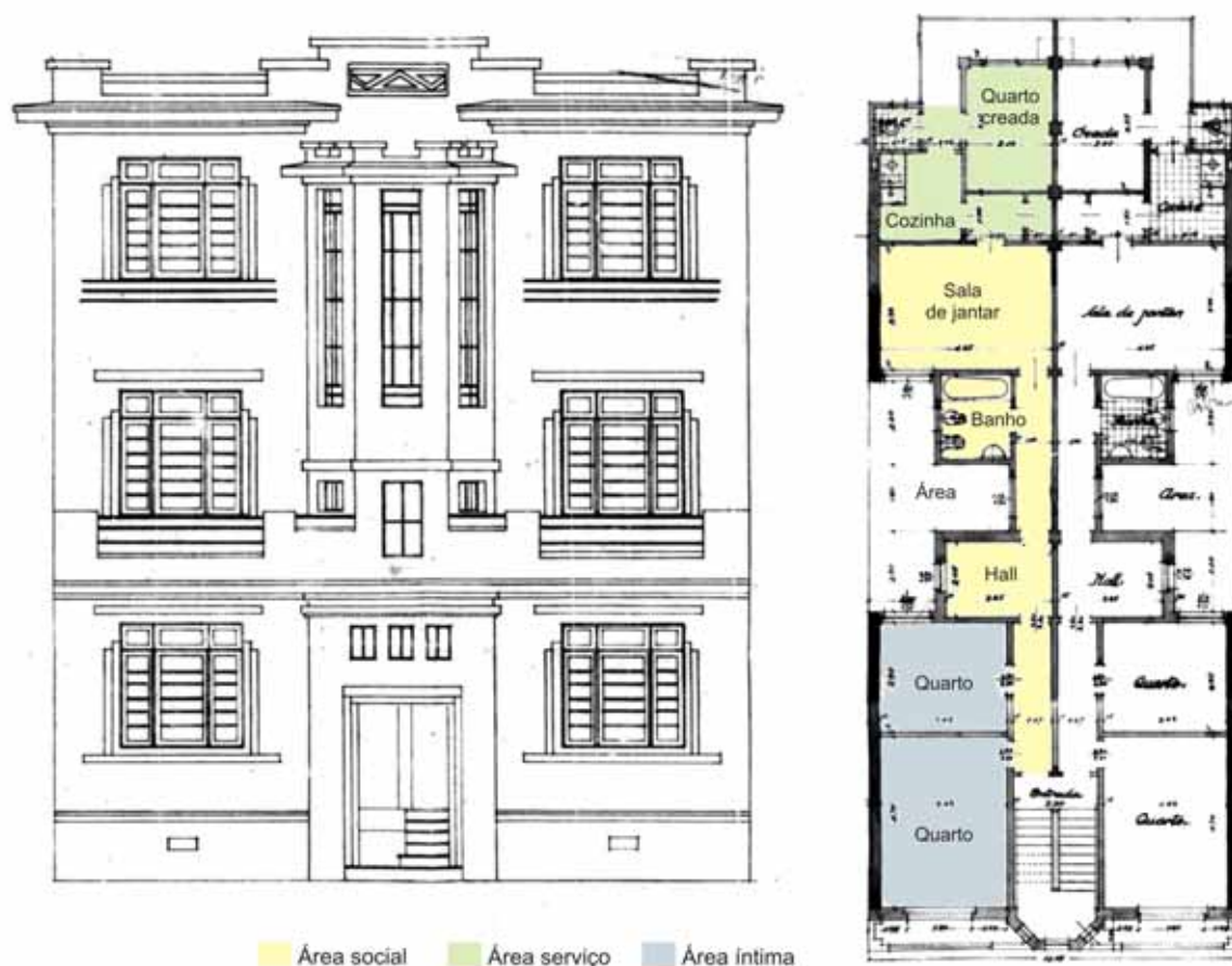
Imagem 128 – Edifício Francisca Porto Sampaio – fachada e planta, Porto Alegre (1934) – Saul Macchiavello e Antonio Rubio. Fonte: Arquivo Municipal – microfilme nº 059 – (1934) – projeto nº 4.769.
