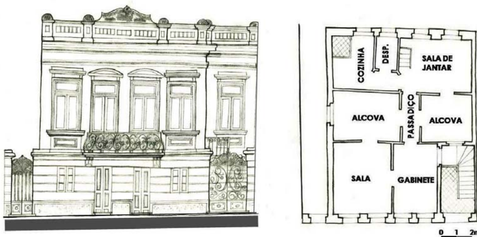
Figura 4 - Casa na Rua Moinhos de Vento s/n, atual Av. Independência, projeto de Vittorio Tellini, 1910; fachada e planta baixa.
