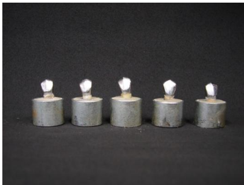
Figura 18- Excesso de poliéter removido. Corpos-de-prova concluídos.
