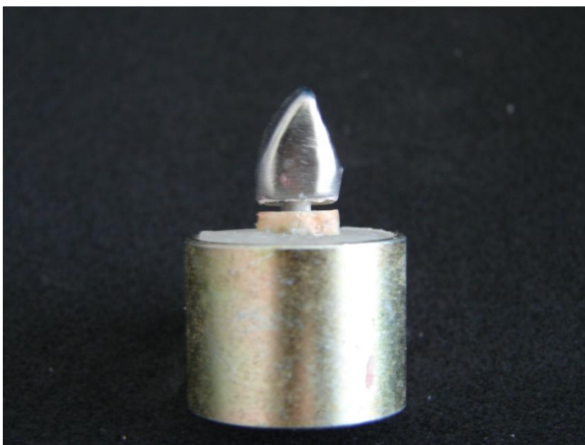
Figura 23- Falha reparável, deslocamento do pino e da coroa.
