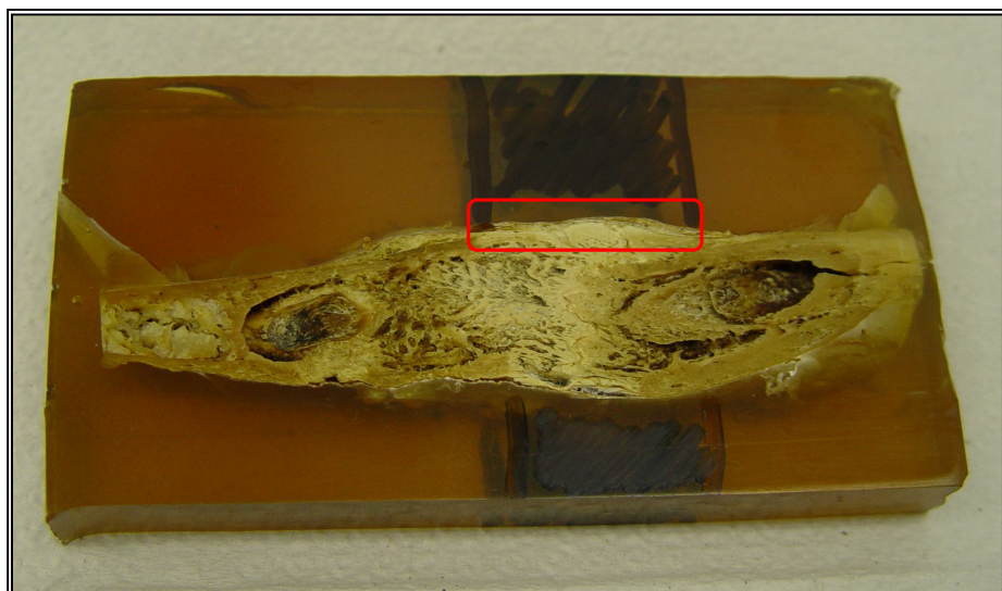
Figura 21 - Bloco ósseo pronto para nanoindentação, polido e com área da distração osteogênica identificada com caneta para retroprojektor. O quadro em destaque mostra a cortical externa onde eram feitas as nanoindentações da cortical operada
