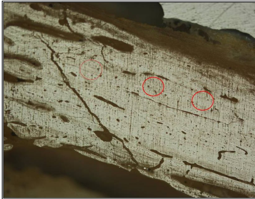
Figura 22 – Demarcações das áreas a serem indetadas sobre a cortical óssea externa em fotomicrografias ópticas em 50x
