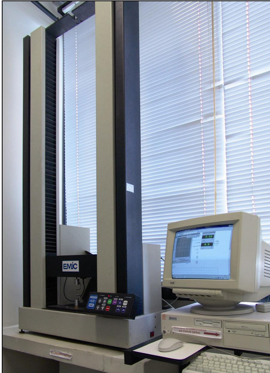
**Figura 6:** Máquina de ensaio mecânico Emic DL2000®.
