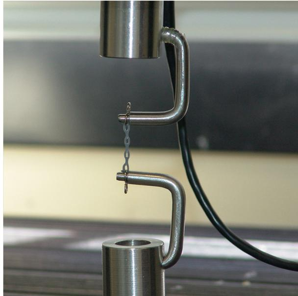
**Figura 7:** Adaptadores de aço em forma de “U” inseridos na máquina com amostra já fixada.
