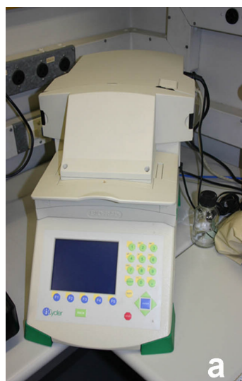
Figura 12 – a) Aparelho ICYCLER (BIO-RAD) para amplificação do cDNA do qRT-PCR e b) software para a leitura da amplificação ICYCLER 3.0.
