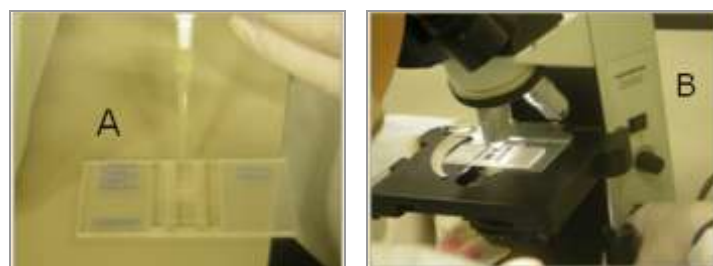
FIGURA 7. Preparo da Câmara de Neubauer (hemocitômetro-A) e posicionamento ao microscópio óptico para a contagem das células (B).
