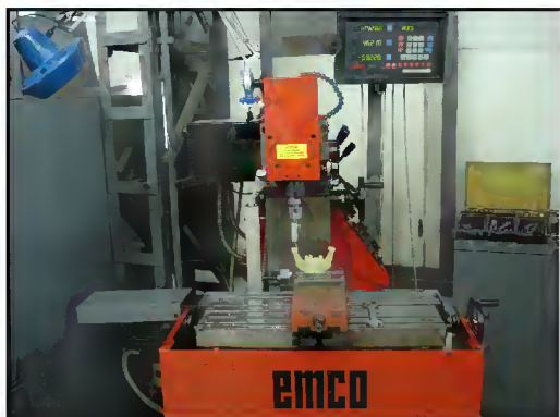
FIGURA 21: Mandíbula posicionada na fresadora EMCO®, acoplada ao apalpador analógico e ao medidor eletrônico.
