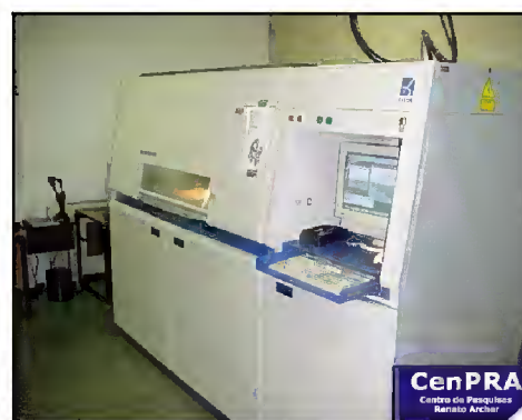
FIGURA 16: Aparelho de SLS (Sinterstation 2000 – DTM, EUA), pertencente ao LTDDP-CenPRA, Campinas-SP. FONTE: SILVA et al., 2005.
