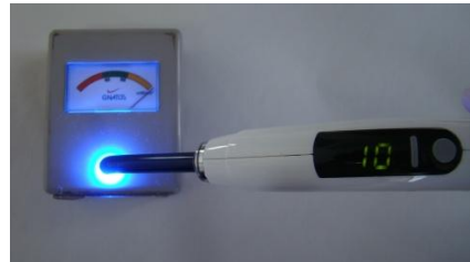
Figura 7 – Intensidade da luz medida no radiômetro.
