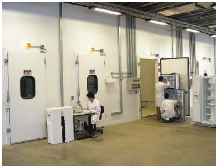
Calorímetros usados em ensaios de eficiência energética
