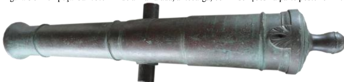
Figura 50 – 01 peça Cal 75.0mm de alma raiada, antecarga, com inscrições na parte posterior “2.2.17”
