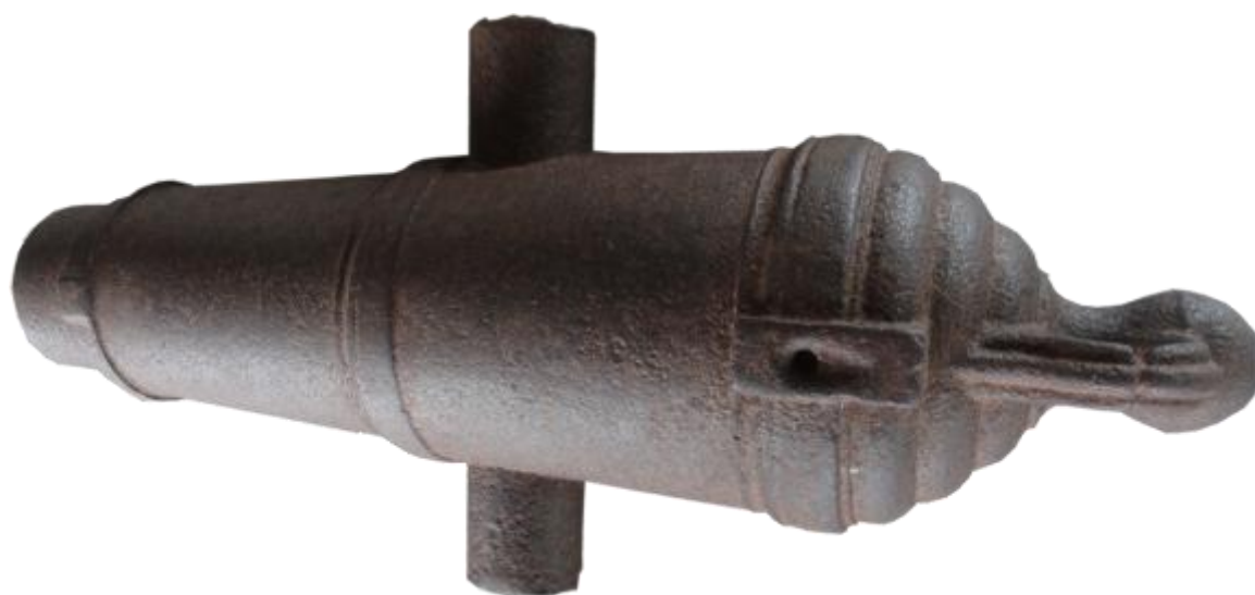
Figura 49 – 01 peça Cal 110.5mm de alma lisa, antecarga, com inscrições na parte posterior “F SOLID”
