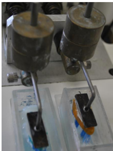
FIGURA 15. Escovas acopladas na máquina, com carga de 200 g e velocidade de escovação de 250 ciclos/min.
