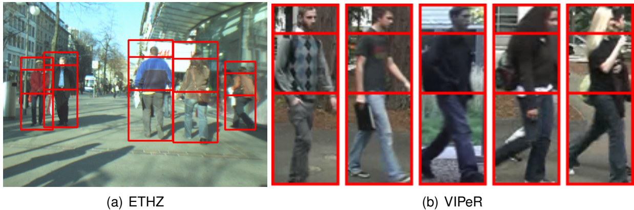
Figura 4.3 – Detecção de pessoas e divisão do corpo em atributos em uma cena do banco ETHZ (a) e em um subconjunto do banco VIPeR (b) (redimensionados para efeitos de visualização).
