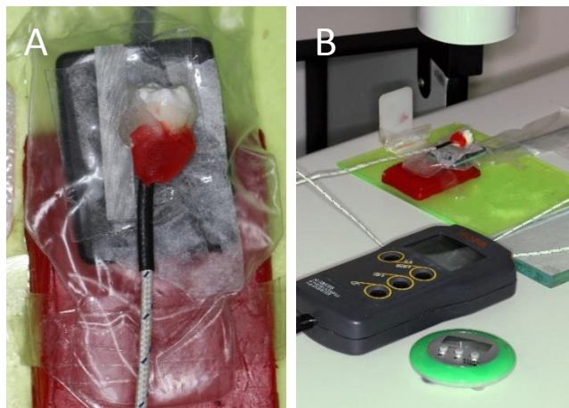
Figura 3. A) termopar, dente e sensor digital fixados sobre o dispositivo confeccionado para o estudo; B) posicionamento do cabeçote do raio x para realização da radiografia.
