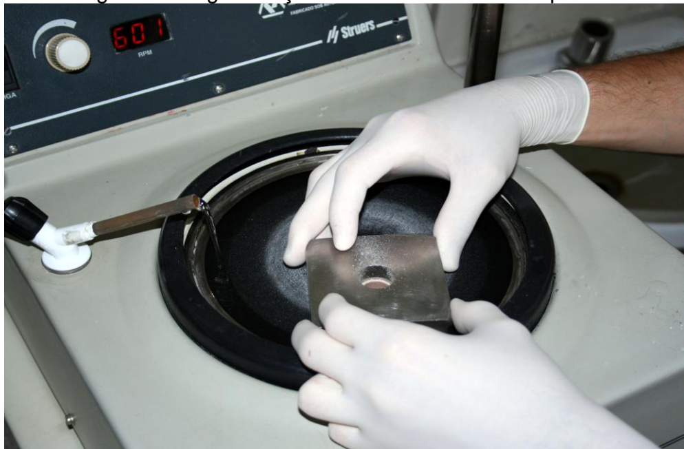
Figura 1 - Regularização do cilindro de PVC em politriz
