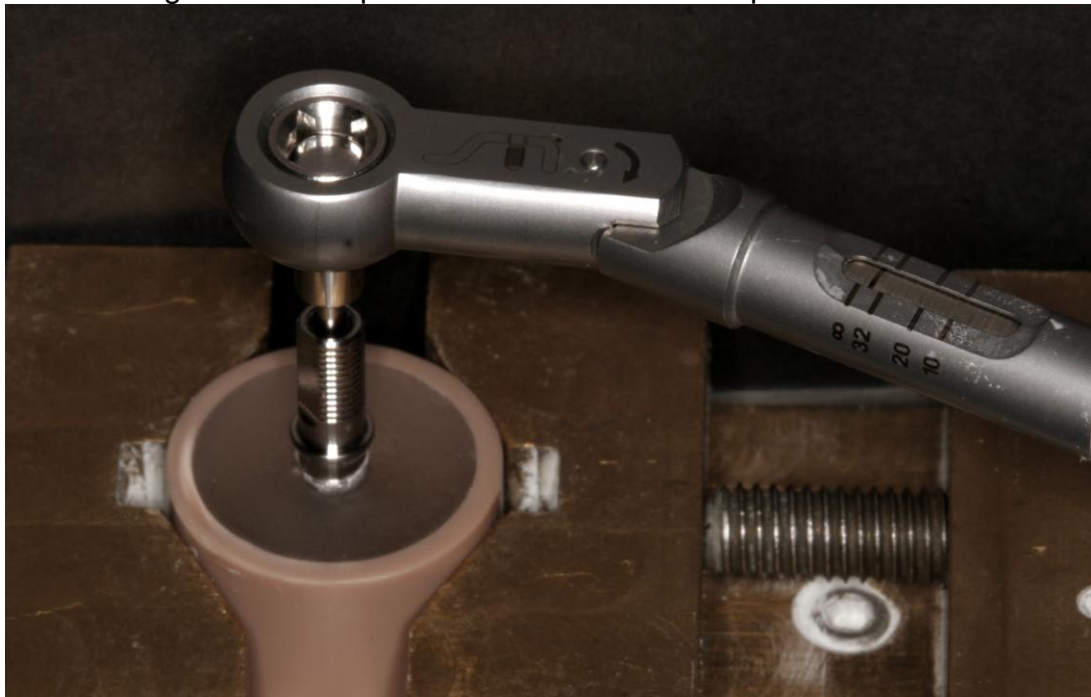
Figura 11 - Torque definitivo recomendado pelo fabricante
