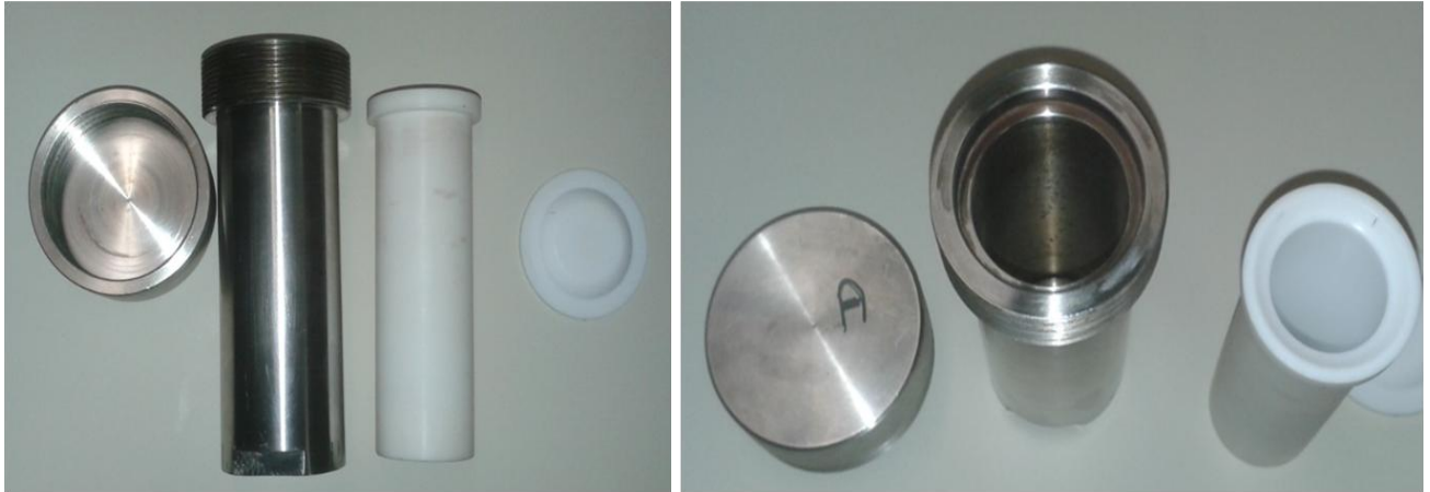
Figura 4.1. Reator do tipo autoclave utilizado para a síntese dos NTT.
